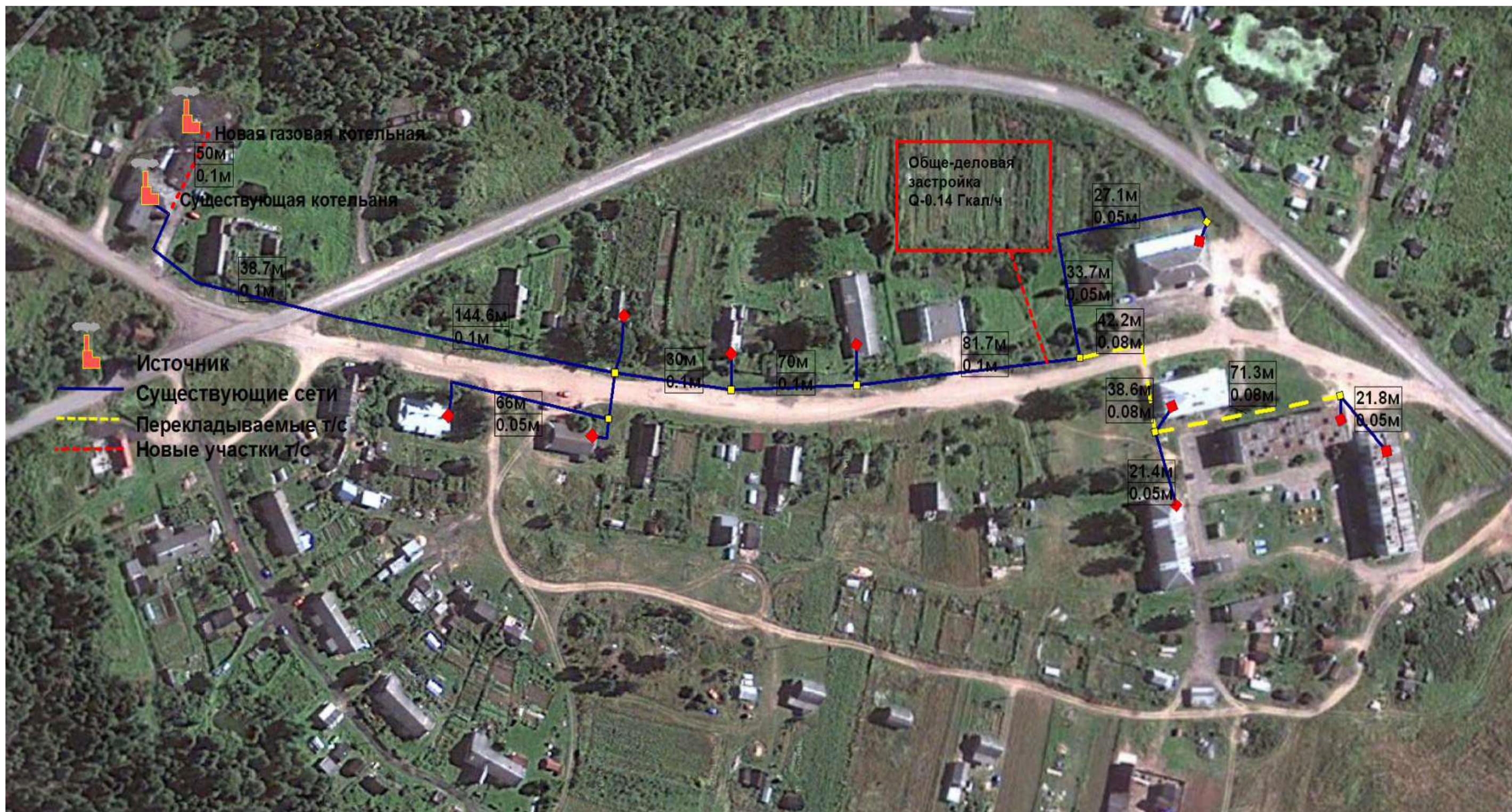
Рисунок 5.1.2.1. Схема теплоснабжения с новой котельной
