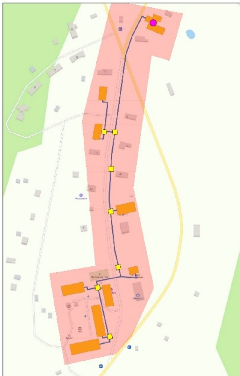
Рисунок 1.4.1 – Зона действия централизованного теплоснабжения котельной
