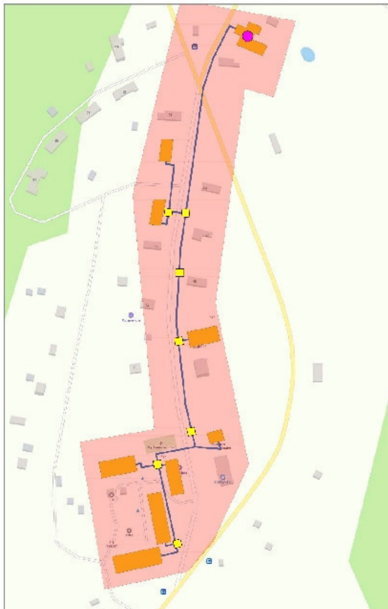
Рисунок 1.4 – Зона действия централизованного теплоснабжения котельной д. Сухое
