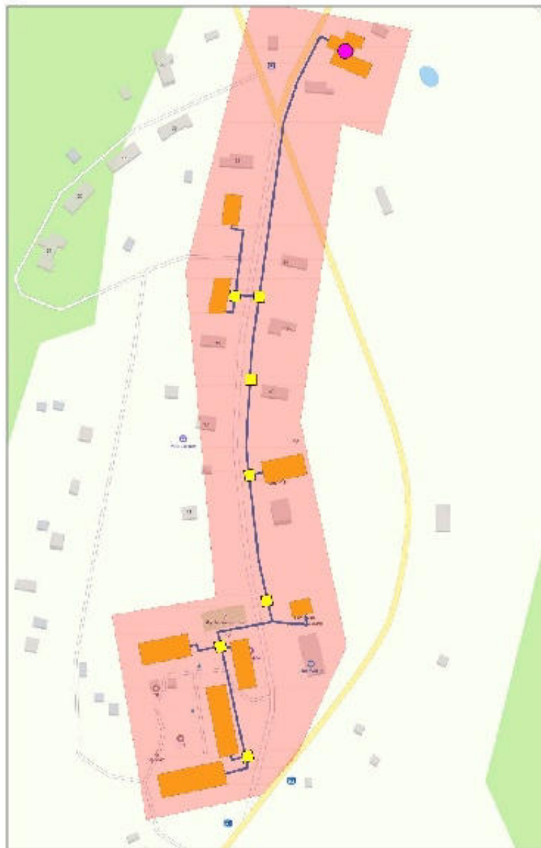
Рисунок 1.4 – Зона действия централизованного теплоснабжения котельной д. Сухое
