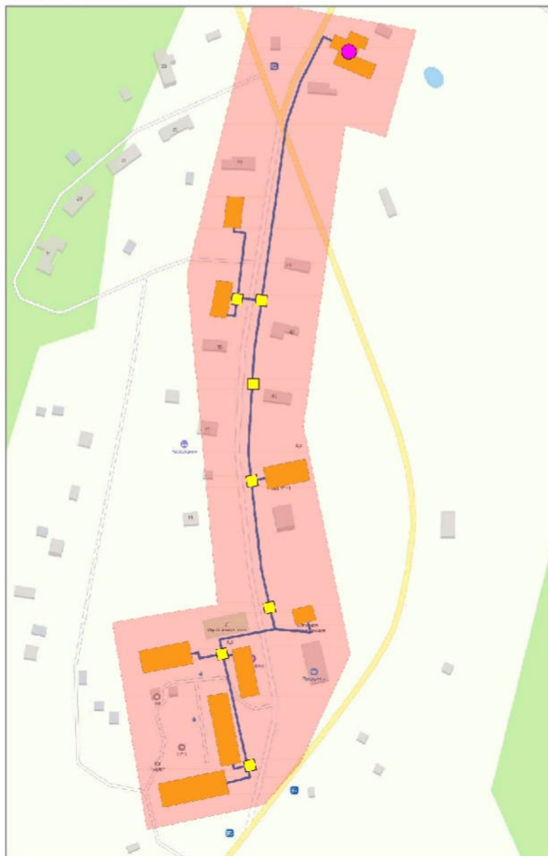
Рисунок 1.4 – Зона действия централизованного теплоснабжения котельной д. Сухое
